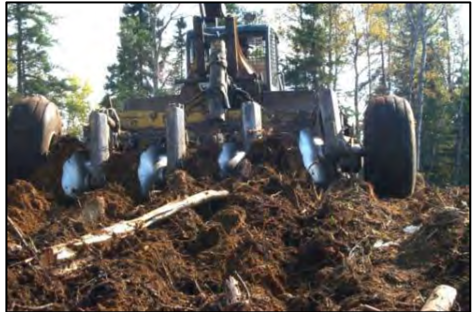
Herse forestière montée sur une débusqueuse
