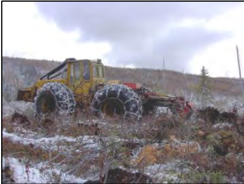
Scarificateur TTS mécanique monté sur une débusqueuse
