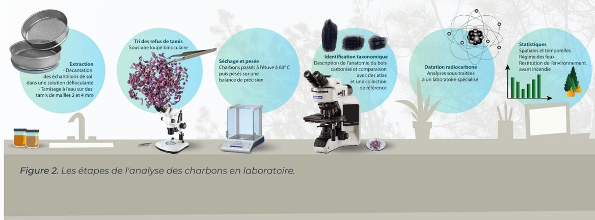
Figure 2. Les étapes de l'analyse des charbons en laboratoire.
