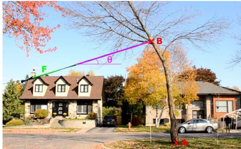
$$M = T_x(B_y - A_y) + T_y(B_x - A_x) \text{ ou } T_x = F \cos(\theta) \text{ et } T_y = F \sin(\theta)$$
