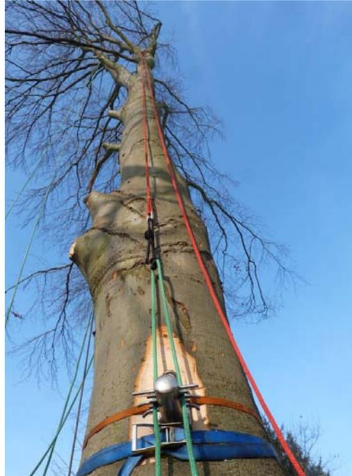
1. Résistance mécanique de la **base** de l'arbre
