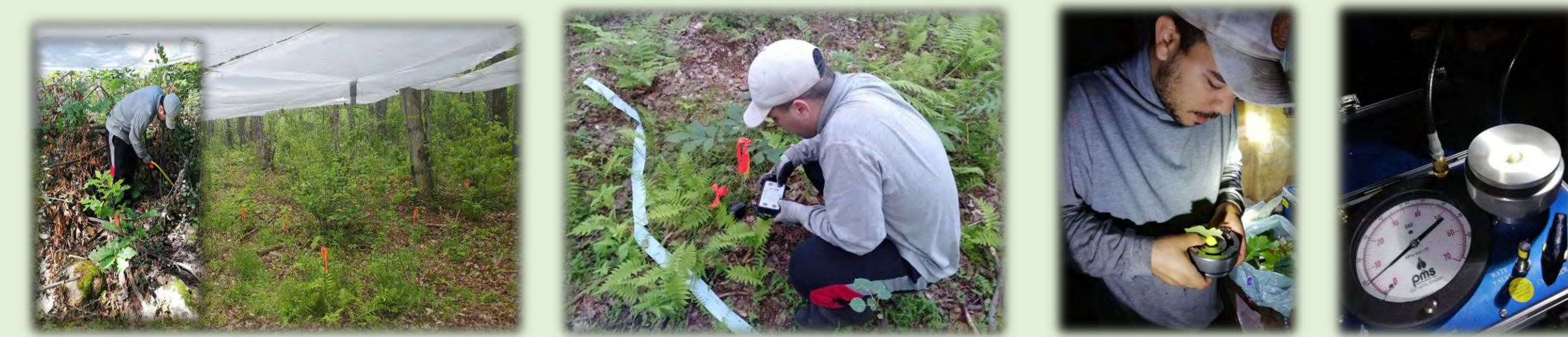
Figure 4 : A gauche : l'expérience de l'exclusion des précipitations et le dégagement de la concurrence végétale dans le sous-bois. Au milieu, les mesures du contenu volumétrique de l'eau du sol avec la TDR (Field scout). A droite, la prise de mesures du potentiel hydrique des feuilles avant l'aube avec une chambre à pression (PMS model 100).
