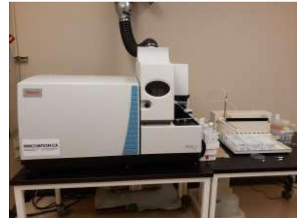
Spectromètre de masse (ICP-MS)
