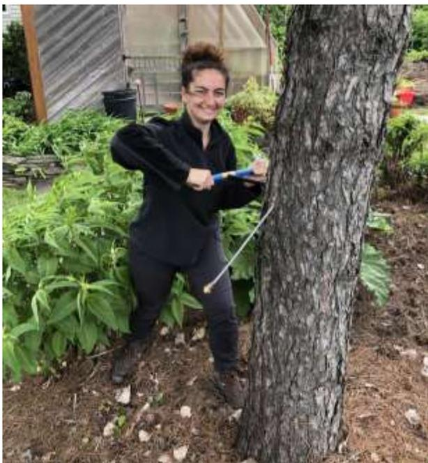
Carotte d'arbre avec une sonde de Pressler (Ø 1,2 cm)
